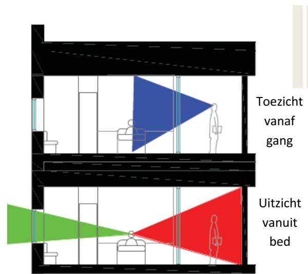
Figuur 24. Doorsnede 1pers.patiëntkamer WKZ, toezicht en uitzicht. Bron:Kopvol
