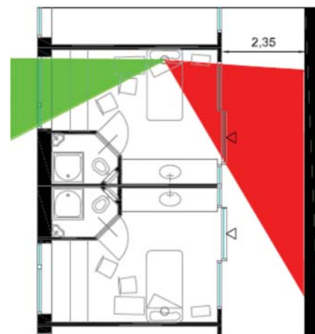
Figuur 23. Plattegrond met zichtvelden van 1pers.-patiëntenkamer WKZ, Bron: KOPVOL.
